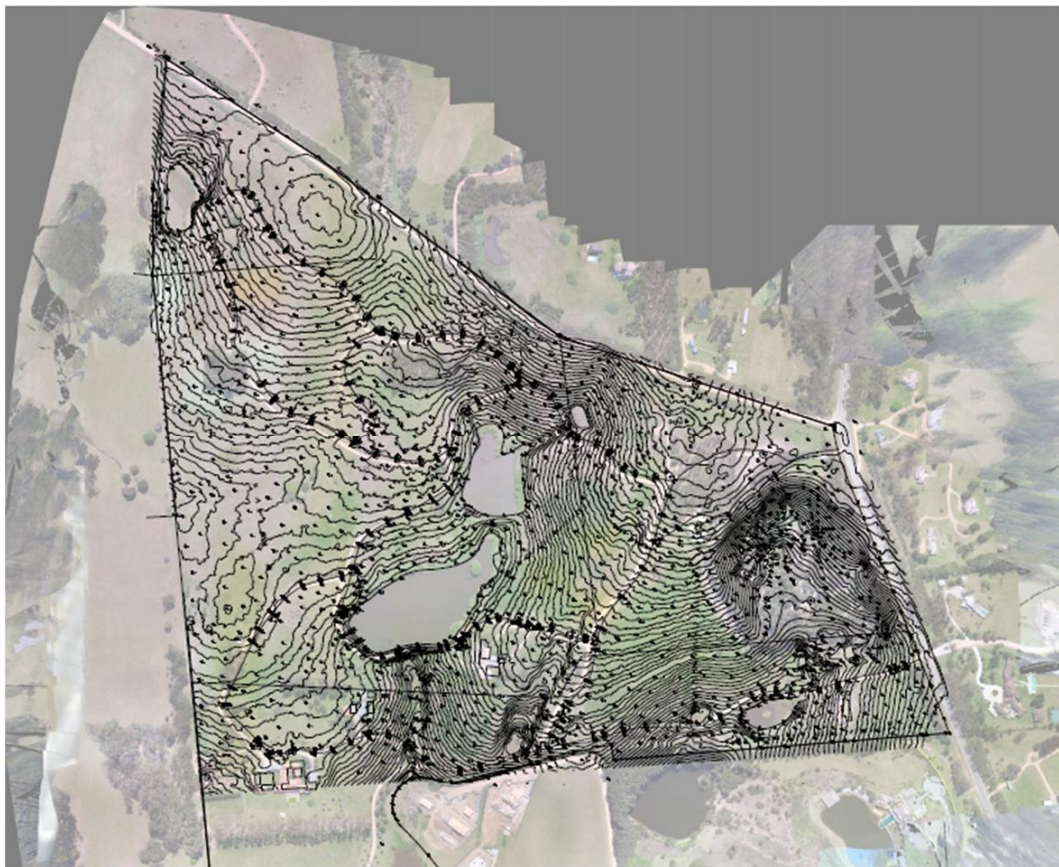
Figura N°15: Relevamiento Topográfico (Sistema Altimétrico Cero Oficial). Fuente: GEA Consultores.
